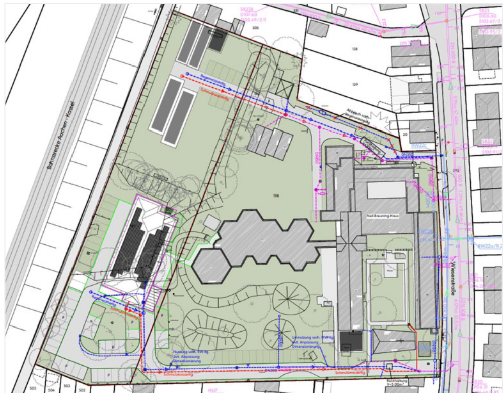
Abbildung 4-2: Schematische Darstellung der möglichen Grundstücksentwässerung
