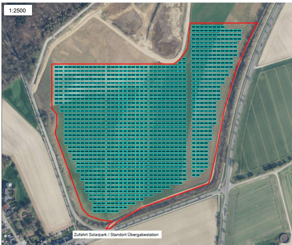
**Abb. 6:** Derzeitige Abgrenzung des Solarparks mit möglicher Darstellung der Modulanordnung.
